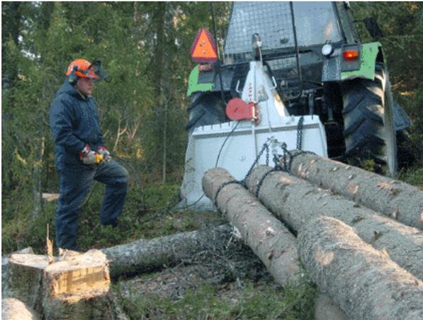
Das **FARMI Seilwindenprogramm** besteht aus zwei Linien. Die Farmer Linie deckt den Bedarf für den Landwirt und Privatwaldbesitzer mit zweckmäßigen und preisgünstigen Seilwinden bis 6 Tonnen Zugkraft ab. Die Profi Linie wurde für den überbetrieblichen, professionellen Einsatz gebaut (ALP Modelle 5.5 bis 8.5 Tonnen Zugkraft). Die Modulbauweise erlaubt bei allen Modellen eine mechanische, elektro-hydraulische oder Funkfernbedienung, welche auch jederzeit nachrüstbar ist.
