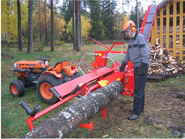
Neu im Farmi Programm ist der **Master-split Säge-/Spaltautomat** im 3-Punkt-Anbau zu finden. Leises Sägen mittels einer Kettensäge und schnelles Spalten mit patentiertem, automatischem Holzvor-schub – und das in einem Arbeitsgang. Mit der Schnellfunktion bis zu 50 Säge- und Spaltvorgänge pro Minute - da macht die Herstellung von Brennholz plötzlich Spass!
