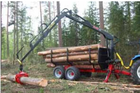
Die **FARMI Forstkrane/Anhänger VARIO und PROFDRIVE** mit 10 resp. 12 to. Nutzlast, lassen betreffend Ausrüstungsvarianten keine Wünsche mehr offen. Hydraulischer Rollen- oder Nabenantrieb, Zwei- oder Vierradbremsten, Zweihebel- oder Funkbedienung. Hervorragend geeignet für den professionellen Forsteinsatz!
